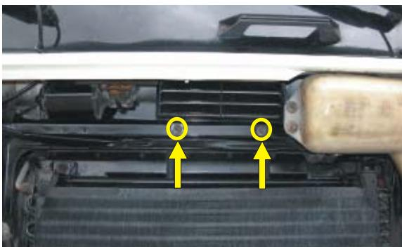
**PL** Odkręcić wkręty pokrywy filtra, usunąć pokrywę
